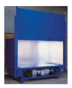
**Wärmekammer** in geschweißter, grundierter und lackierter Ausführung. Rahmen, Stand- und Seitenrohre aus Quadratrohr. Boden mit Untergestell für Transportzwecke.
