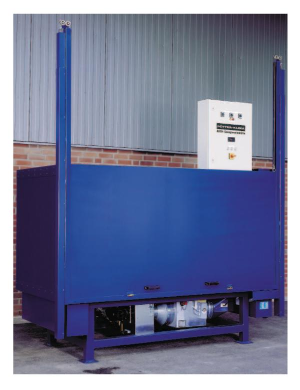
Wärmekammern mit Hochleistungs-Radialventilator
