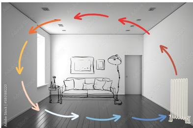
Warme Heizungsluft steigt nach oben und sinkt abgekühlt auf der gegenüberliegenden Wand nach unten
